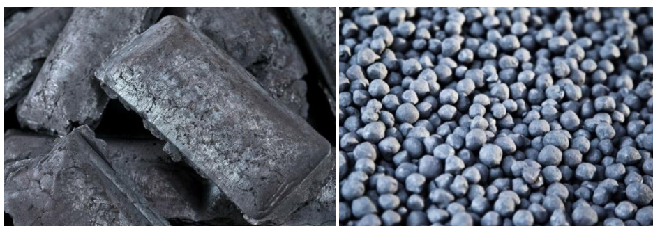
Рисунок 1 – Металлическая часть шихты для выплавки стали (ГБЖ - горячебрикетированное железо, металлизированные окатыши)
