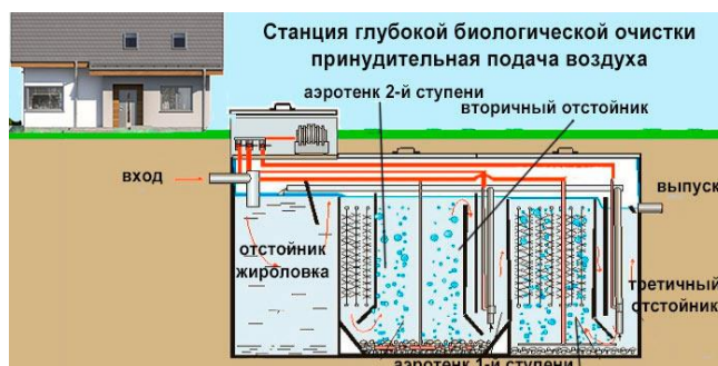
Рис. 3. «Схема устройства станции глубокой биологической очистки»
