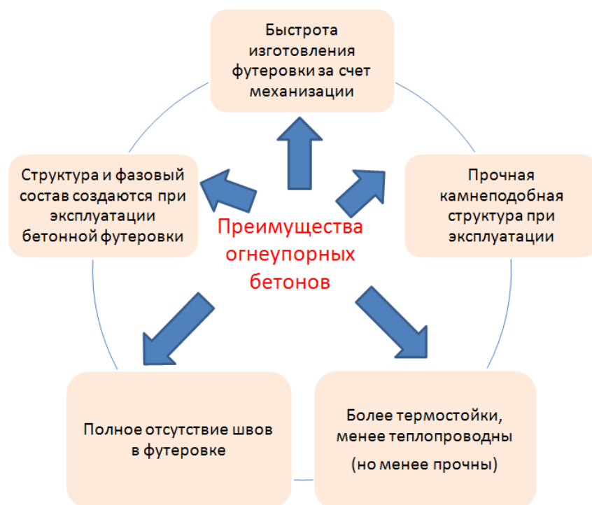
Рис. 1 – Преимущества использования огнеупорных бетонов (на основе данных [3, 4])
