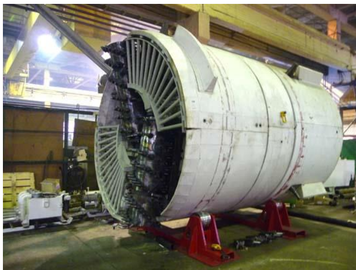
Рис. 1 – Опытный образец геохода модели «401» диаметром 3,2 м
