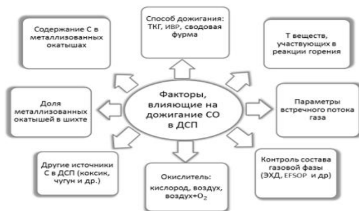
Рис. 1 – Факторы, влияющие на дожигание монооксида углерода в ДСП
