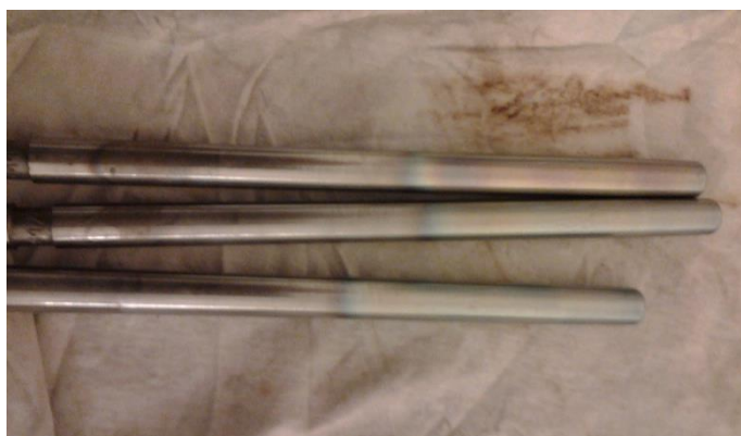
Рис. 3 – Пуансоны вытяжки после нанесения покрытия
