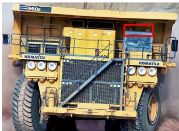
Рис. 8 – Проблесковые маячки, установленные на крыше кабины Komatsu 960E
