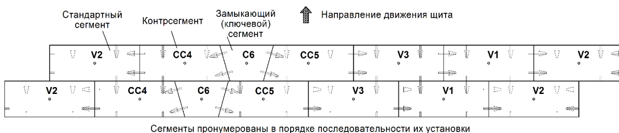
Рис. 1 – Развертка кольца прямоугольной блочной (сегментной) тоннельной обделки
