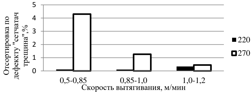
Рис. 4 – Влияние скорости разливки стали на отсортировку проката по дефекту «сетчатая трещина»
