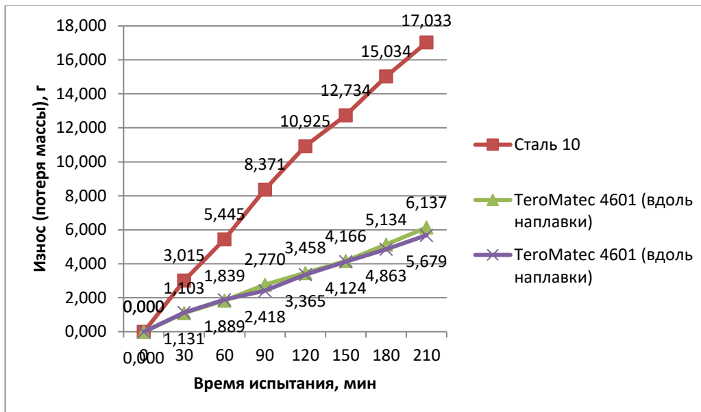
Рис. 3 – Зависимость износа образцов от времени истирания
