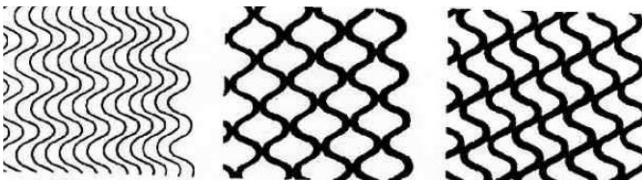
Рис. 5 – Формирование регулярного микрорельефа осевыми колебаниями деформирующего инструмента
