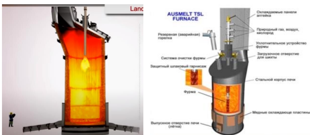
Рис. 1 – Общий вид печного агрегата Ausmelt
