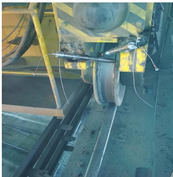
Рис. 2 – Гребнесмазыватели с композитными смазывающими стержнями на холостом колесе мостового крана [1]
