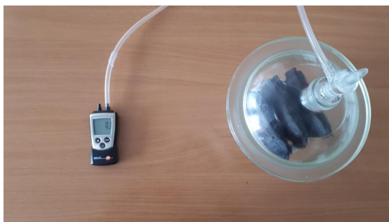
Рисунок 2 – Установка для определения окисления ГБЖ
