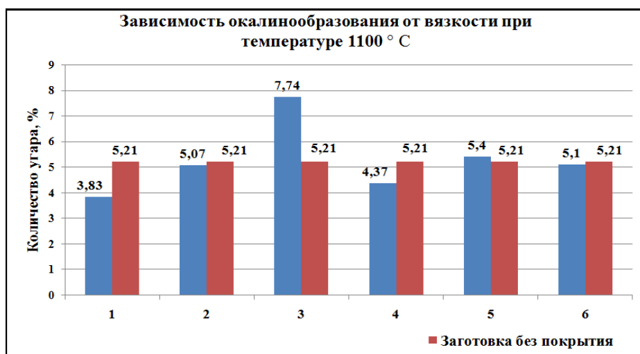
Рисунок 3 – Зависимость окалинообразования для образцов без покрытия и с покрытием
