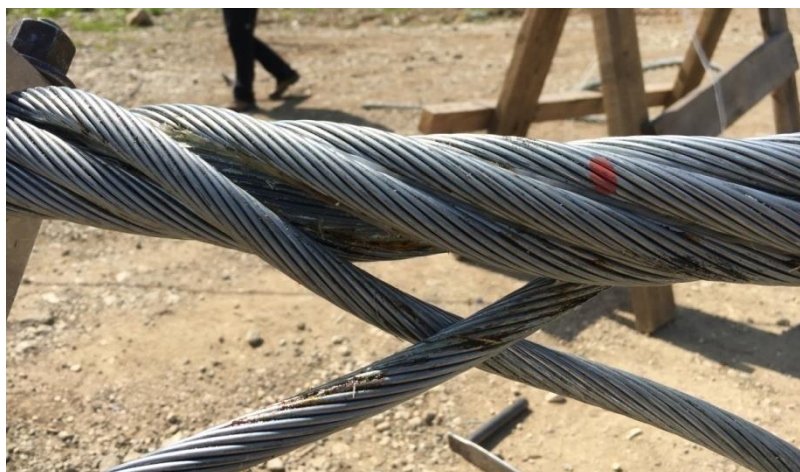
Рис. 2. Место стыковки прядей при счаливании несуще-тягового каната
