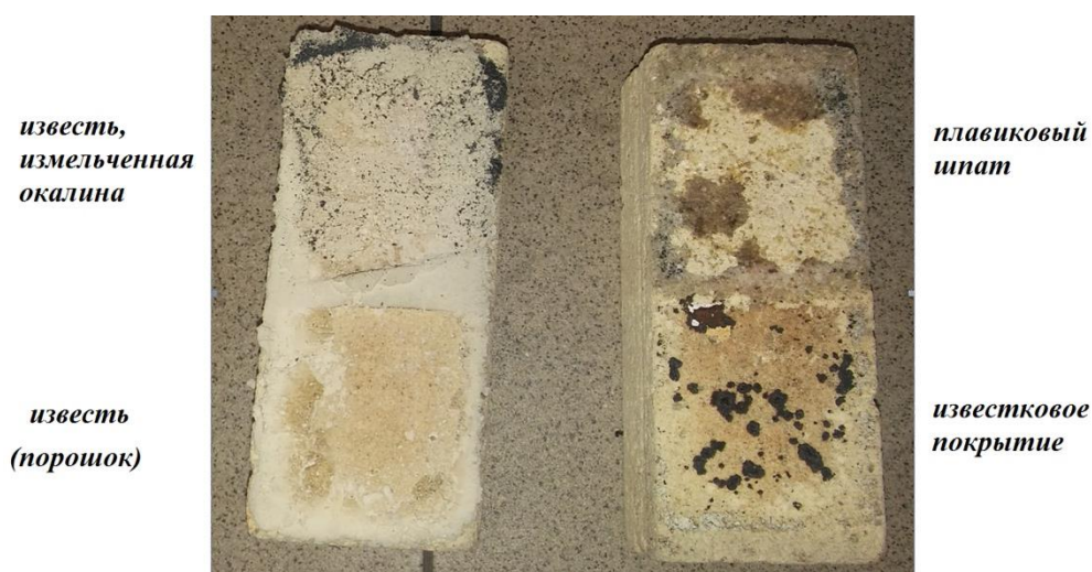
Рисунок 2 – Состояние поверхности огнеупоров
