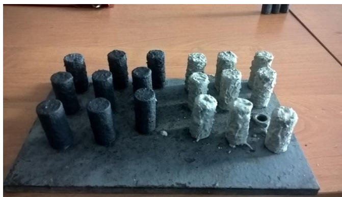
Рисунок 4 – Заготовки с нанесёнными защитными покрытиями (справа первое покрытие, слева – второе)
