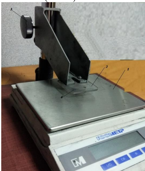
Рисунок 4 – Лабораторная установка для определения прочности сырых окатышей на сжатие
