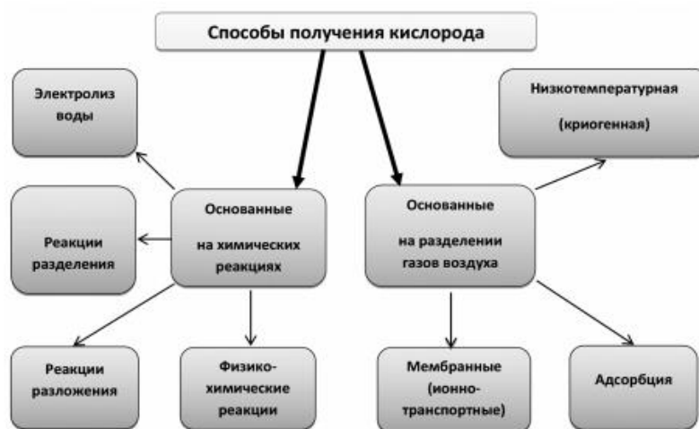
Рисунок 1 – Классификация способов получения кислорода [2]
