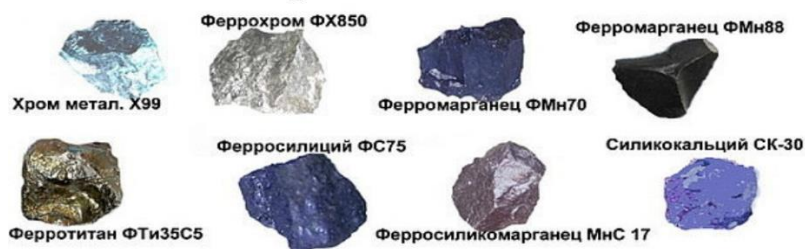
Рисунок 1 – Сплавы железа применяемые для раскисления и легитирования стали
