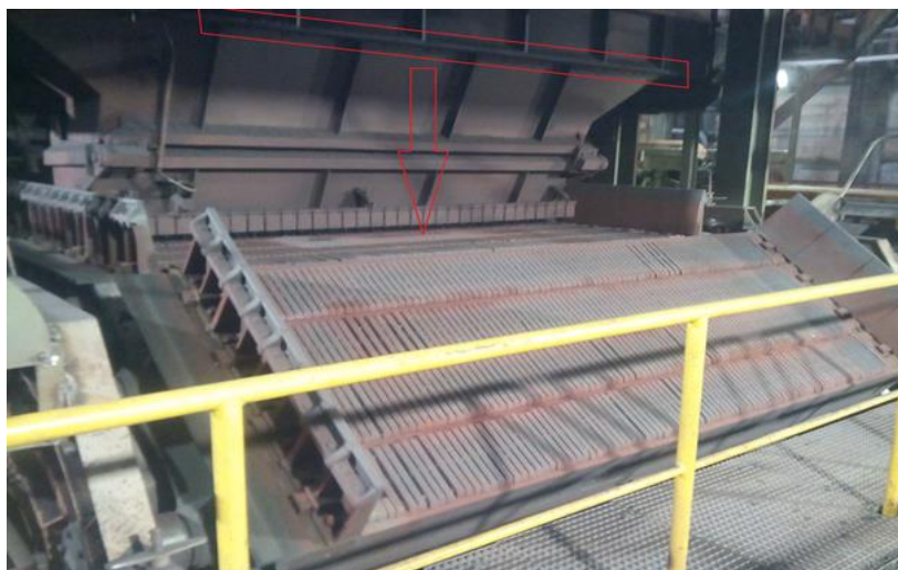
Рисунок 2 – Место установки камеры машинного зрения на обжировой машине
