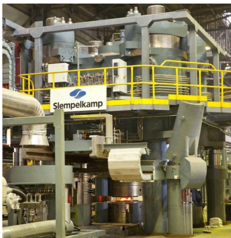
Рисунок 1 – Внешний вид гидравлического пресса усилием 200 МН
