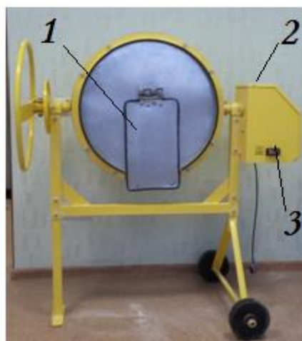
Рисунок 3 – Устройство для определения прочности во вращающемся барабане 1 - загрузочный люк; 2 - электропривод; 3 - кнопки включения и выключения барабана
