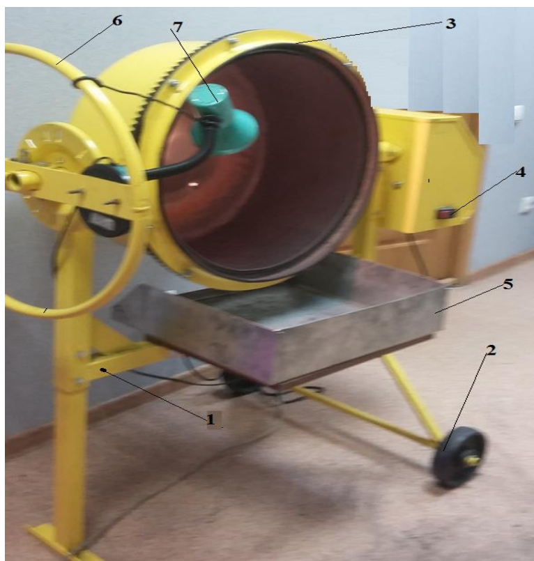
1 - станина барабанного окомкователя, 2 - колесики для свободного перемещения окомкователя, 3 - барабан, в который засыпается шихта и формируются окатыши, 4 - кнопка включения барабана, 5 - поддон для ссыпания сформированных окатышей, 6 - колесо-рычаг, с помощью которого можно управлять углом наклона барабана, 7 - лампа для подсветки
