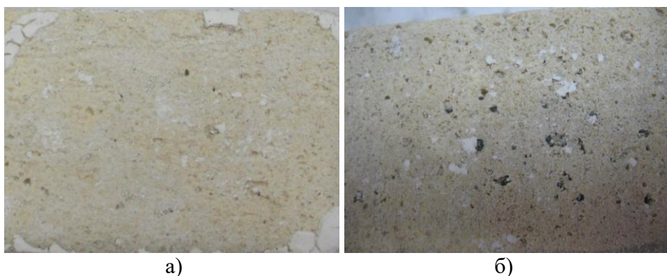
Рисунок 4 – Поверхность огнеупора: а) с подсыпкой извести на огнеупор, б) с покрытием на металлическом образце
