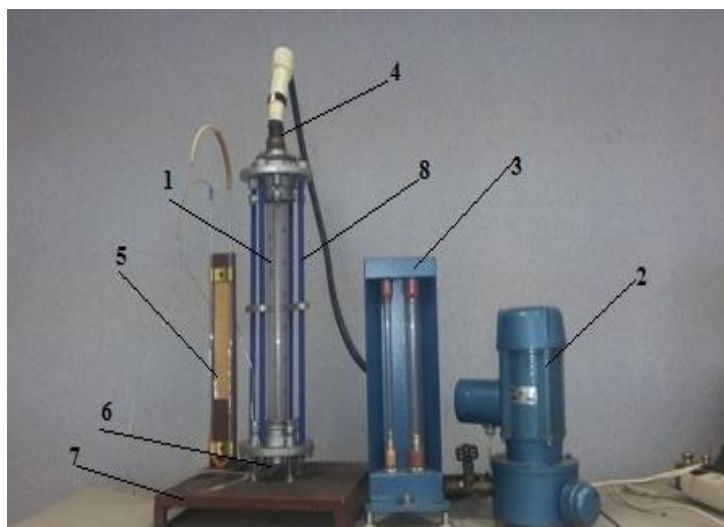
Рисунок 1 – Установка для исследования скорости материала от гранулометрического состава сыпучего материала
