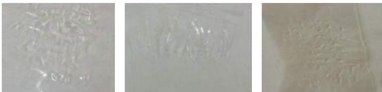
а) плёнка клея на основе бромбутилкаучука б) плёнка клея на основе хлорбутилкаучука-139 в) плёнка клея на основе бутилкаучука-187
