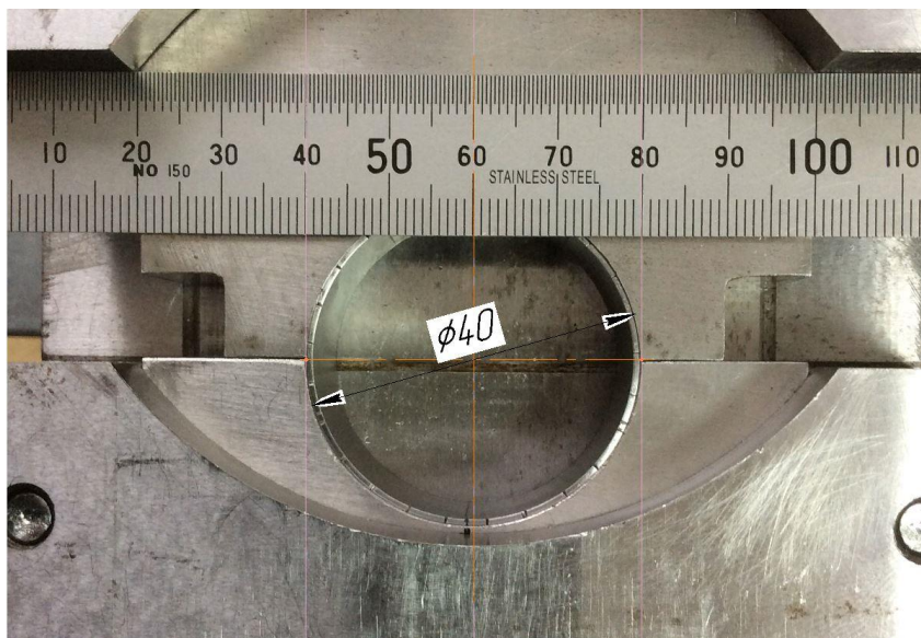
Рисунок 4 – Трубная заготовка цилиндрической формы под нагрузкой при окончательной формовке
