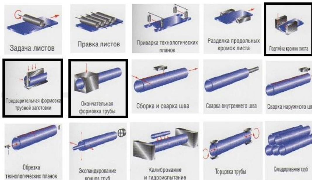
Рисунок 1 – Основные технологические операции в линии ТЭСА 1020
