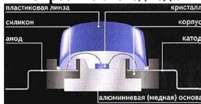
Рисунок 1. Строение светодиода
