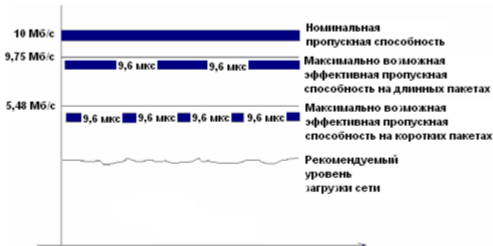
Рисунок 1 «Диаграмма передачи кадров Ethernet»
