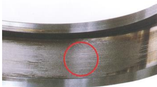
Рисунок 1 – Абразивный износ подшипника
