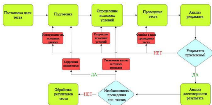
Рисунок 3- Типовая схема проведения опытных работ при выборе технологических режимов
