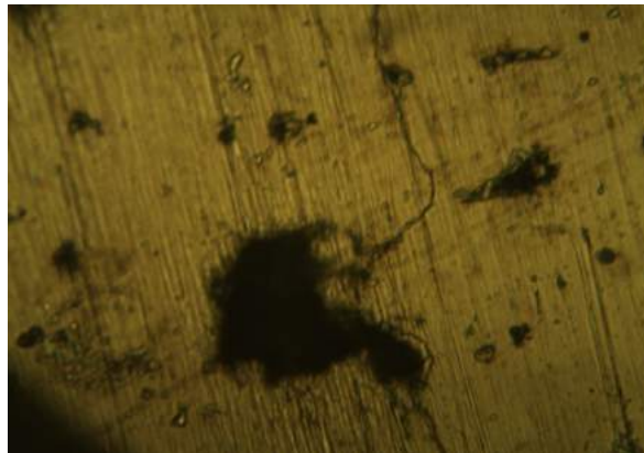
Рисунок 2 - Микроструктура края шлифа (2мм от края), увеличение x150
