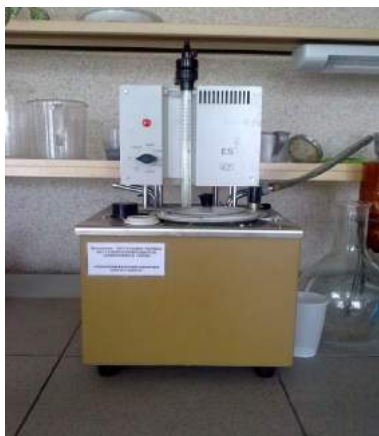
Рис.3 Термостат для расплавления парафина.
