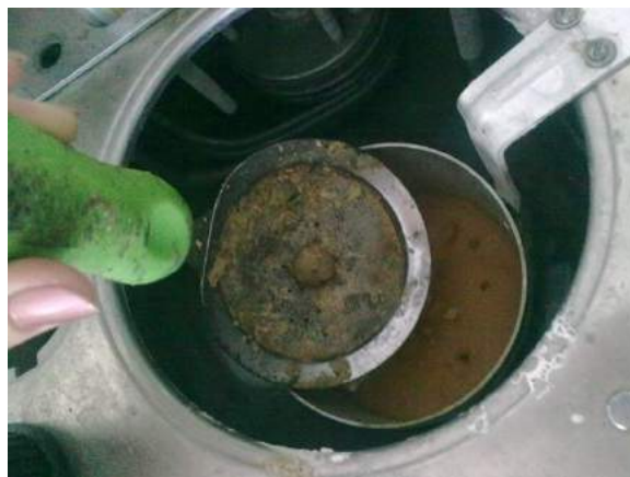
Рис.4 Извлечение окатыша из парафина.
