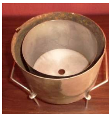
Рис. 9. Два соосных цилиндра с отверстием в центре: внутренний – для определения вязкости испытуемой жидкости или суспензии; внешний – для поддержания температуры в гидросистеме
