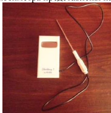
Рис. 7. Термометр для определения значений температуры испытуемой жидкости или суспензии
