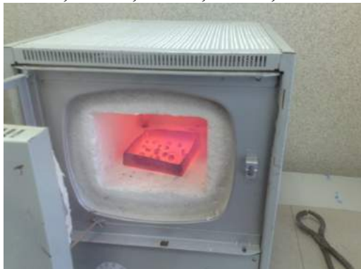
Рис.1 Термообработка окатышей. Рис.2 Извлечение обожженных окатышей из печи.
