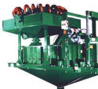
Обезвоживающий грохот, питаемый батареей гидроциклонов
