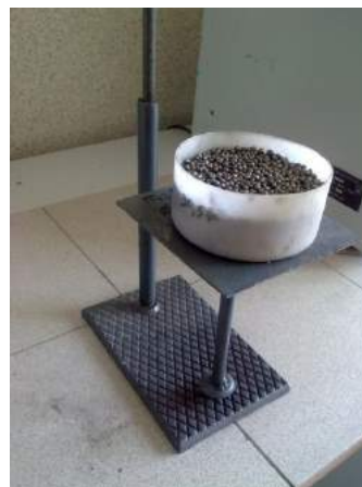
Рис.7 Прибор для определения прочности окатышей
