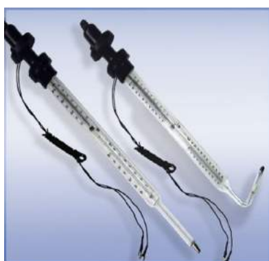
Рис. 8. Термометр для определения значений температуры водяной бани
