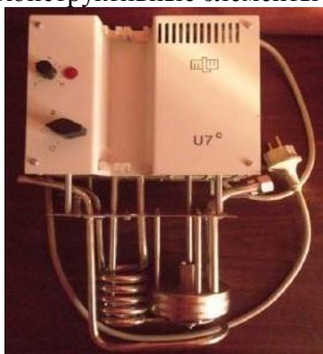
Рис 6. Термостат для поддержания постоянной температуры водяной бани
