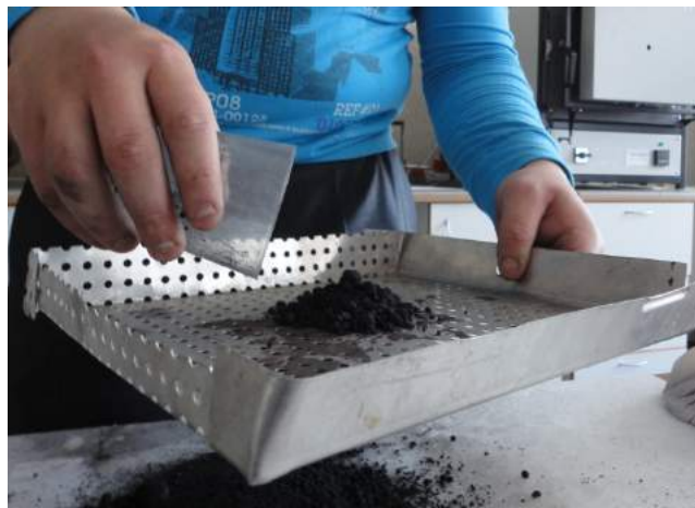
Рис.3. Рассев окатышей на разных ситах
