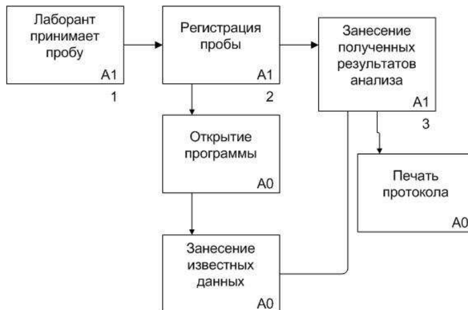
Рис.2. Процесс «Как будет» регистрации полученной пробы лаборантом хим.анализа
