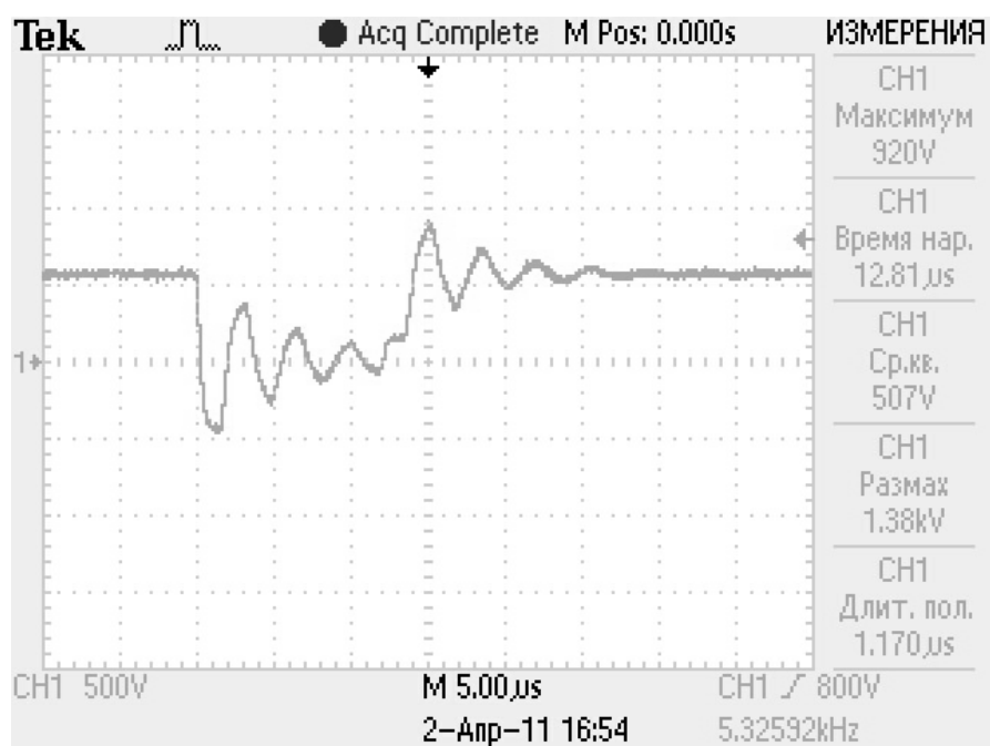
Рис. 3. Осциллограмма напряжения на зажимах двигателя (увеличен масштаб по оси времени)
