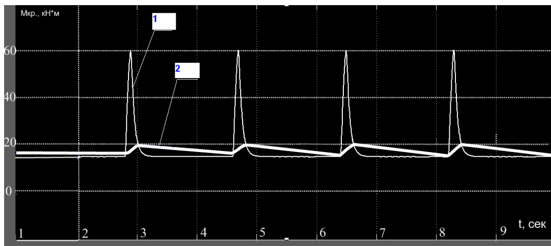
Рис. 2. Зависимости момента на валу электродвигателя при импульсной нагрузке: 1 – с жёсткой муфтой; 2 – с гидромеханической муфтой
