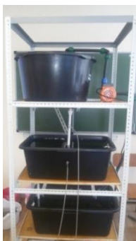
Рис 1 Лабораторная модель стальковша и промковша
