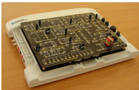
Рисунок 2. Рабочая плата лабораторной станции «NI ELVIS II»
