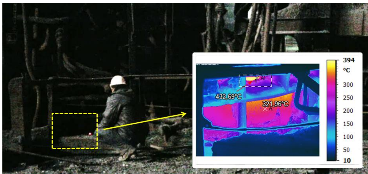
Рис. 3 – Эффективность использования тепловизора при анализе температуры кожуха ДСП [2]
