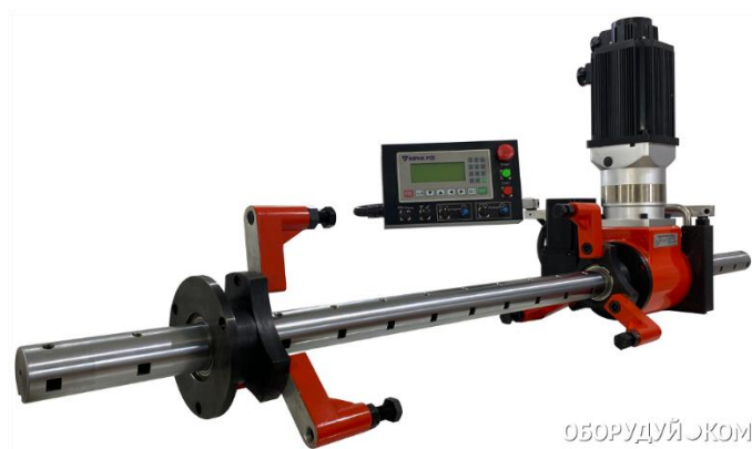
Рис. 3 – Общий вид мобильного расточно-наплавочного комплекса компании РУССТАНКОМ
