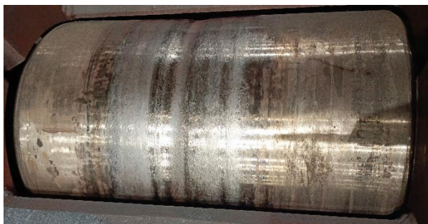
Рис. 6 – Внешний вид ролика №3 за 9,3 месяца эксплуатации
