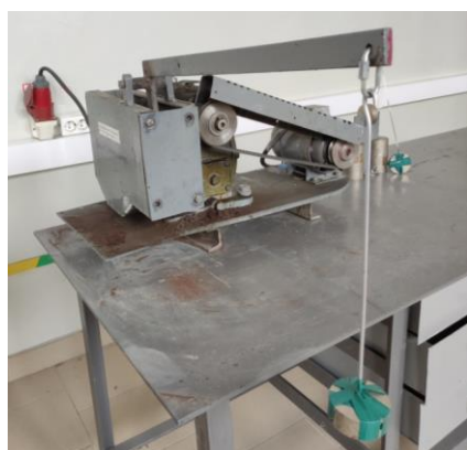
Рис. 1 – Установка для испытаний на абразивный износ по схеме Бринелля-Ховарта
