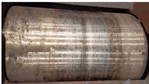
Рис. 8 – Внешний вид ролика №5 за 9,3 месяца эксплуатации
