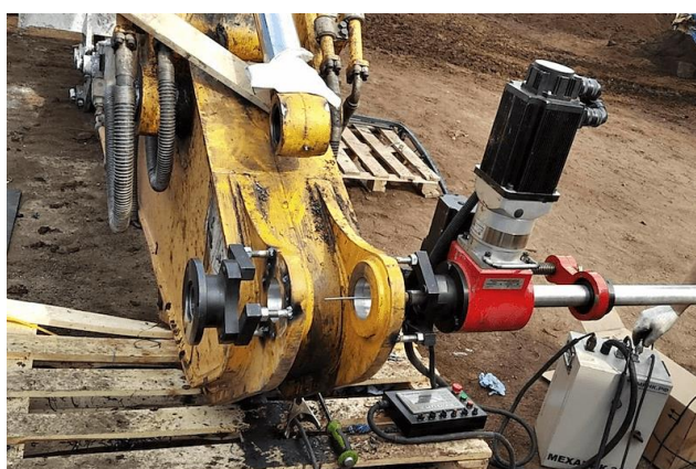
Рис. 1 – Мобильно-расточной комплекс в работе
