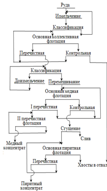
Рис. 1 – Схема коллективно – селективной флотации медно-пиритовых руд
