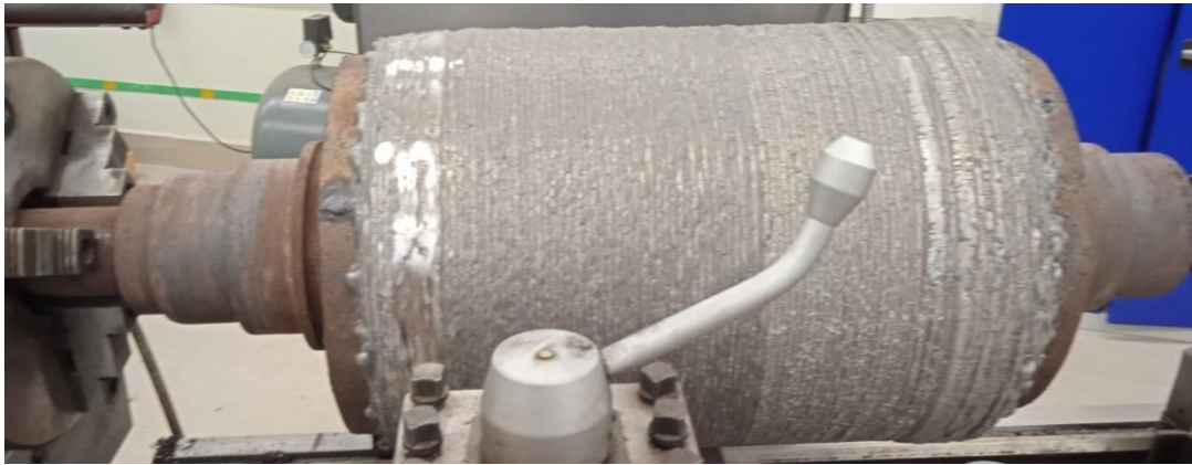
Рис. 3 – Ролик после финишной наплавки порошковой проволокой
