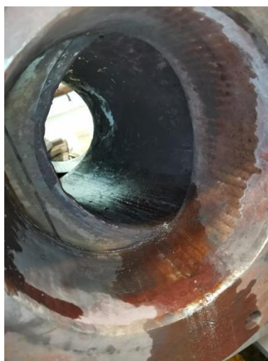
Рис. 2 – Выходное отверстие корпуса клапана с наплавленной поверхностью
