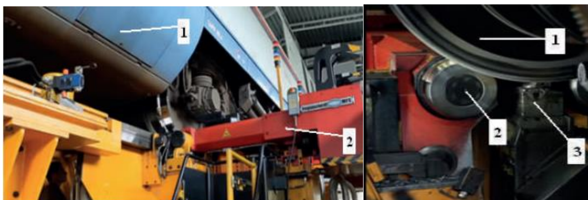
Рис. 2 – Колесно-токарный станок по обточке а – установка локомотива на станке: 1 – локомотив; 2 – станок; б – принцип действия станка: 1 – колесо; 2 – ролик; 3 – резец.
