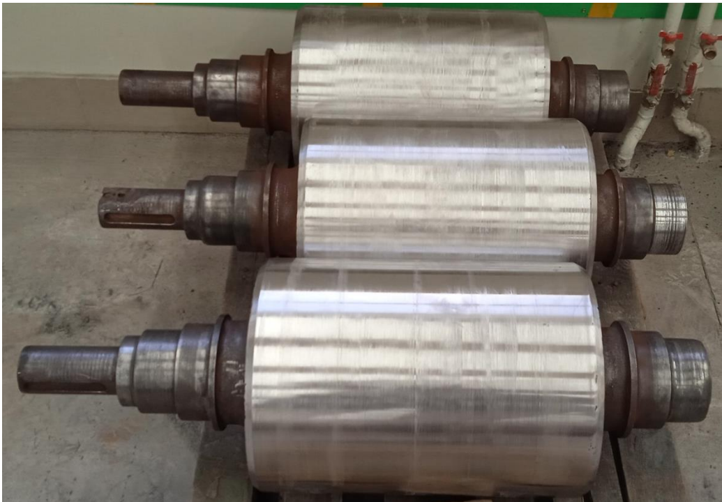
Рис. 4 – Ролики после окончательной механической обработки
