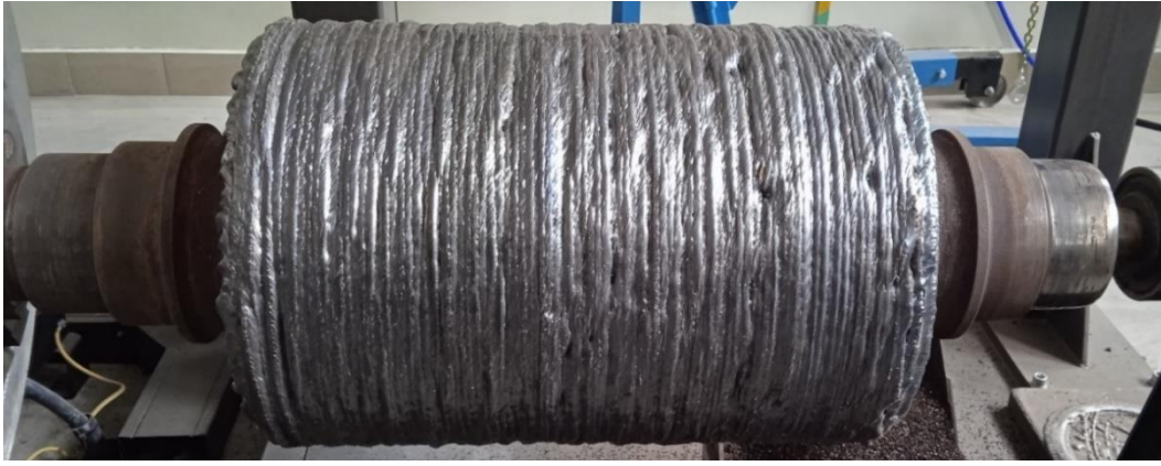
Рис. 2 – Ролик после черновой наплавки проволокой 30ХГСА
