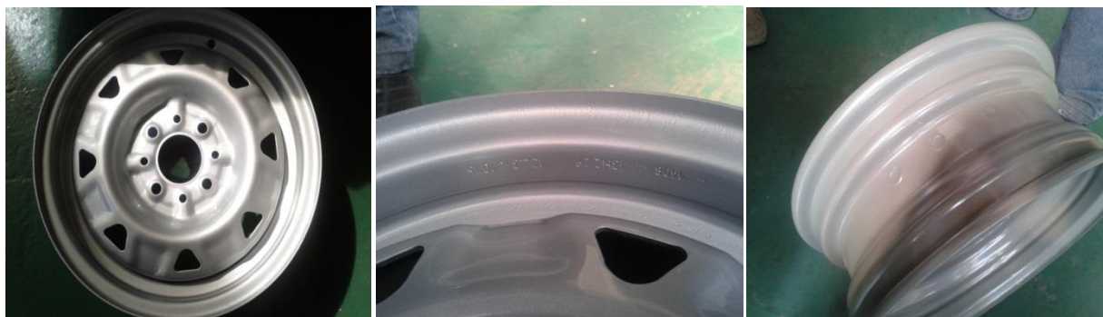
Рисунок 2 – Диск колеса из опытной партии ленты из стали марки 07ГБЮ
