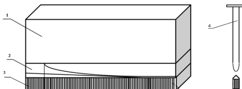
Рис. 5. Плита для поперечно – клиновой прокатки и готовое изделие
