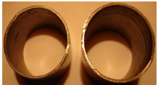
Рис. 5. Вид на поверхности среза при реверсе смещения оправок в заключительной стадии разделения ТТЗ
