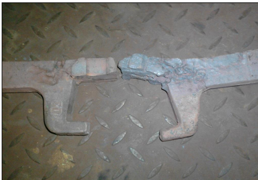
Рис. 3 – Колосники с трещинами в замковой части, снятые с корабленной балки.
