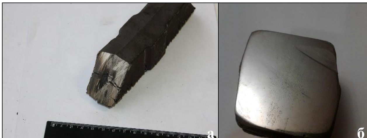
Рис. 2. Пустоты усадочного происхождения в колосниках после 6 месяцев эксплуатации: а - усадочная раковина и проходящая через неё трещина, б – усадочная пористость по всему сечению детали.
