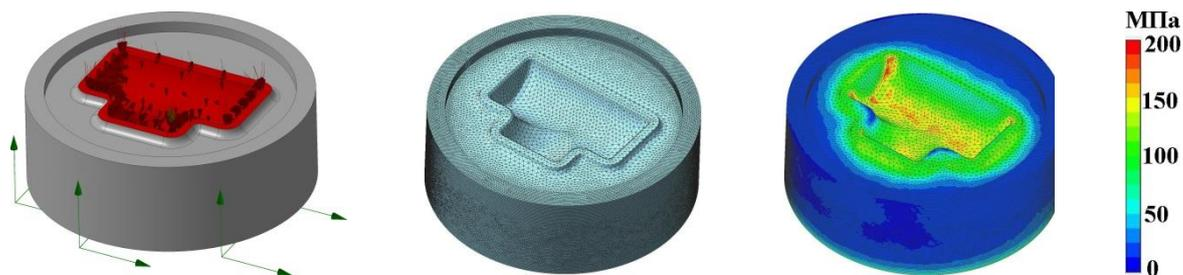
Рис. 4. Модель и результаты расчёта штамповой вставки
