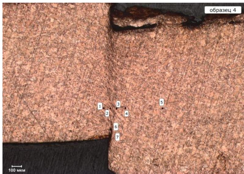
Рис. 3. Разрез образца из меди М1 (x100) подвергнутого первичному деформированию при  $\Delta_1=50\%$  с обозначением точек касания инструмента для измерения микротвердости
