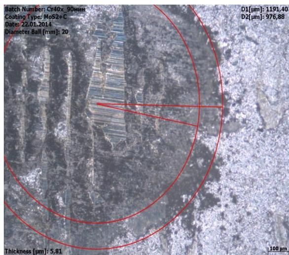
Рис.1. Толщина твердосмазочного покрытия дисульфид молибдена (x100)
