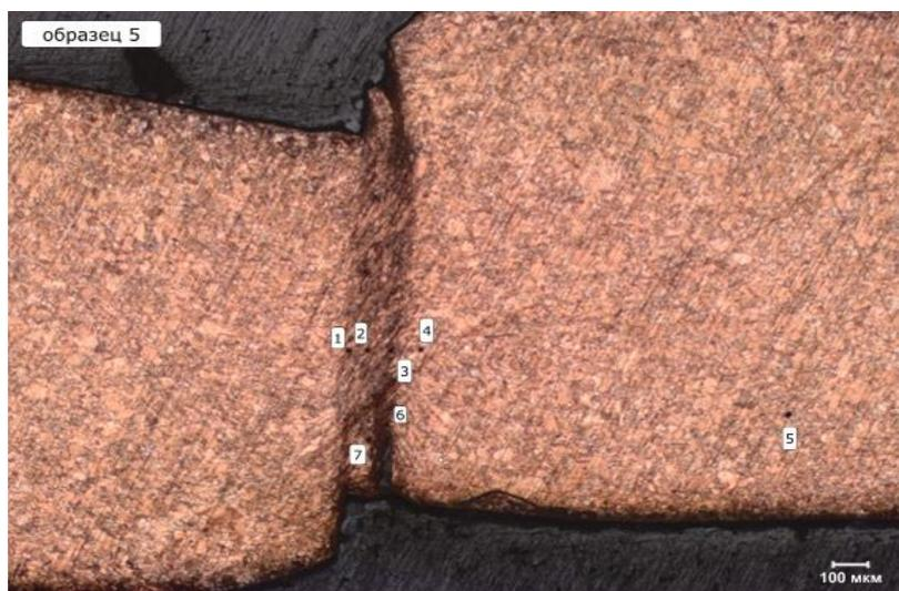
Рис. 4. Разрез образца из меди М1 (x100) подвергнутого реверсивному деформированию при  $\Delta_1=50$  и  $\Delta_2=50\%$  с обозначением точек касания инструмента для измерения микротвердости
