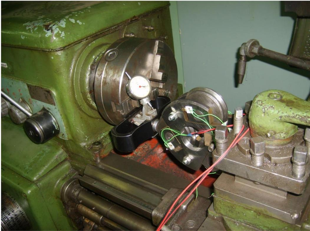
Рис. 5. Тарировка головки
