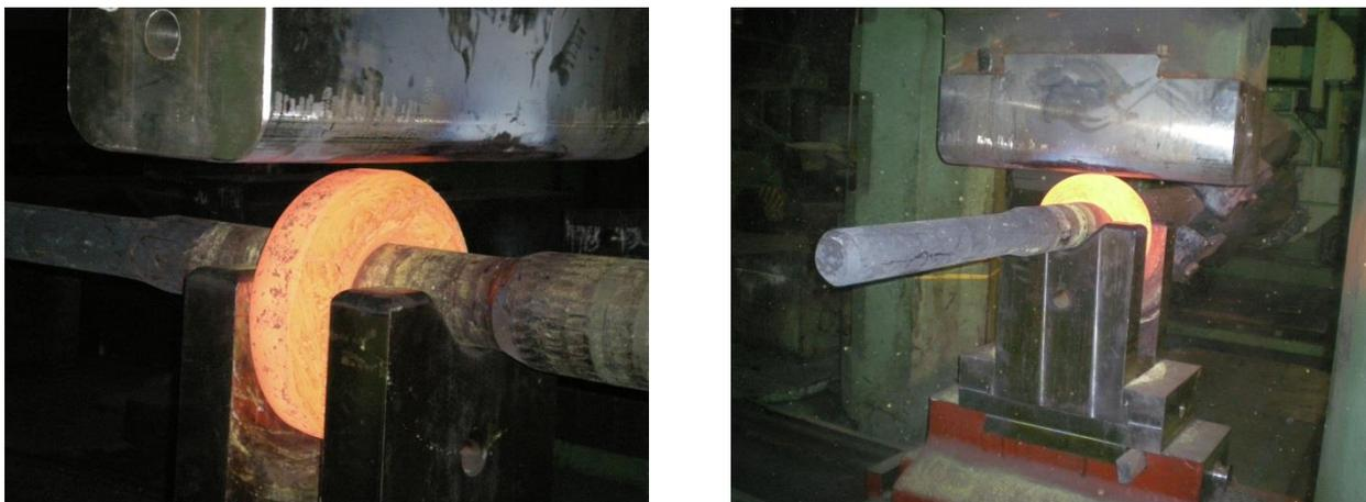
Рис. 3. Кузнечная раскатка заготовок
