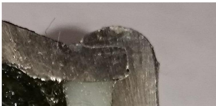
Рис. 4. Осевое сечение шаровой опоры после закатки
