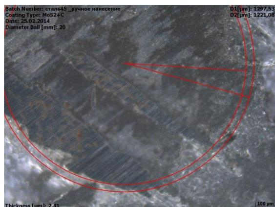
Рис.3. Толщина покрытия дисульфид молибдена нанесенного кистью. Масштаб 100 мкм
