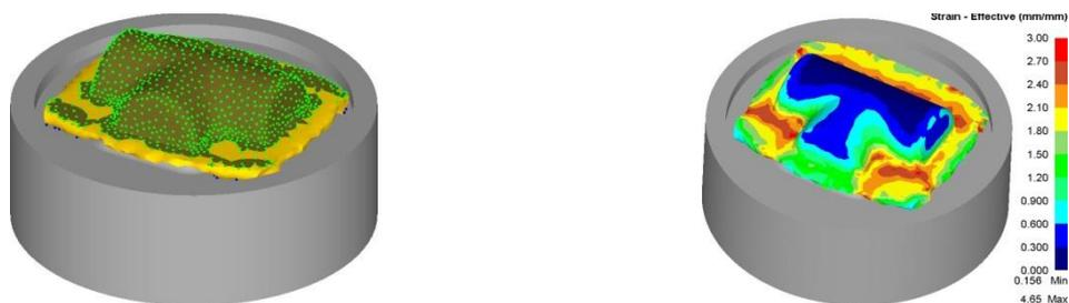
Рис. 3. Моделирование процесса штамповки
