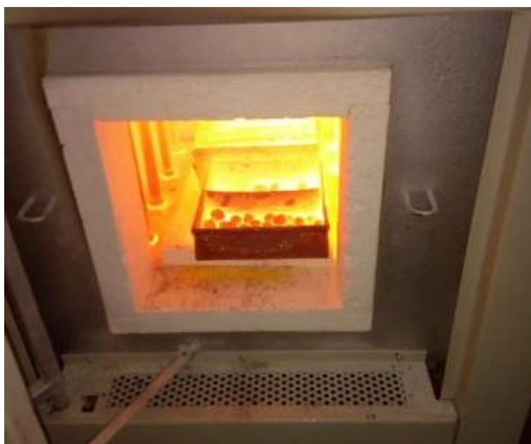
Рисунок 1 – Обжиг окатышей в печи ПТ-200
