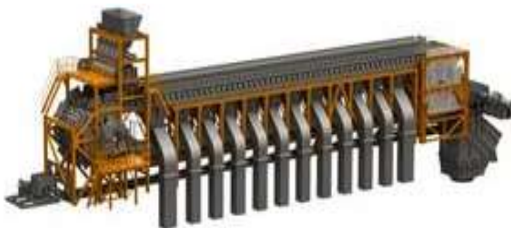
Рисунок 2 – Макет обжиговой машины
