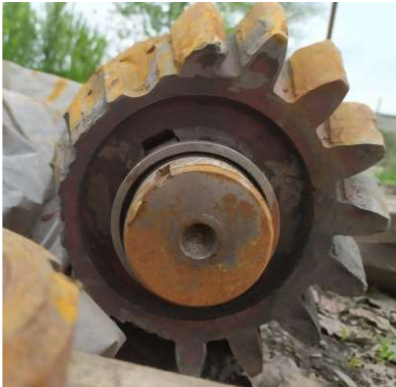
Рисунок 7 – Излом зубьев шестерни
