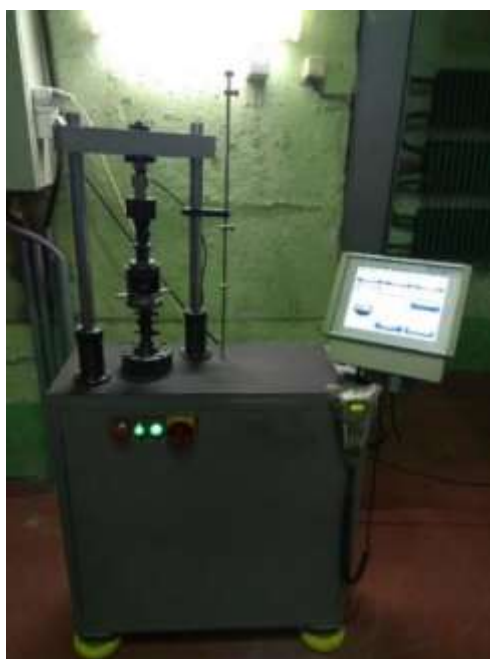
Рисунок 1 – Автоматическая испытательная машина на сжатие модели УТС101
