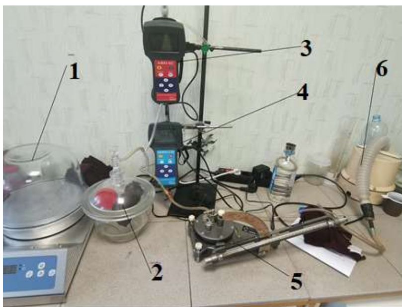
Рисунок 2 – Исследование вторичного окисления ГБЖ при разной температуре 1 – десикатор, для нагрева ГБЖ; 2 – эксикатор, где измеряется поглощение кислорода, брикетами при комнатной температуре; 3 – анализатор водорода; 4 – анализатор кислорода; 5 – микрометр, измеряющий давление в реакционном сосуде; 6 – воздуходувка для продувки системы
