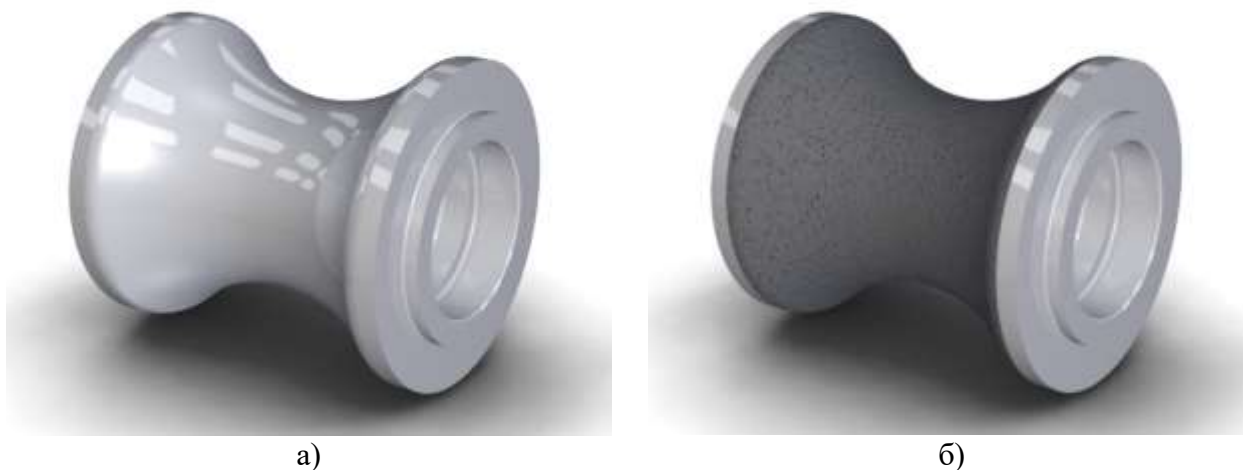
Рисунок 1 – Ролики привалковой арматуры: а – до обработки; б – после нанесения электроискровых покрытий
