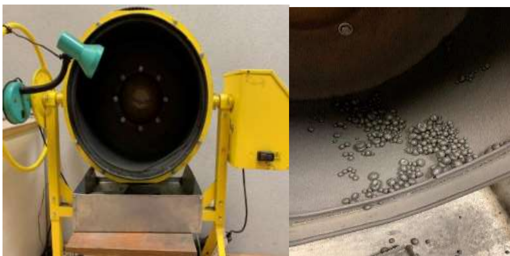
Рисунок 1 – Лабораторный барабанный окомкователь
