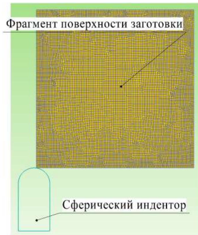
Рисунок 1 – КЭ модель для выглаживания
