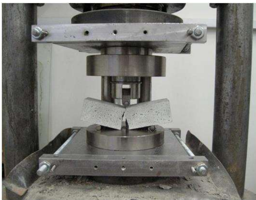
Рисунок 1 – Испытание на прочность обожженного мертеля
