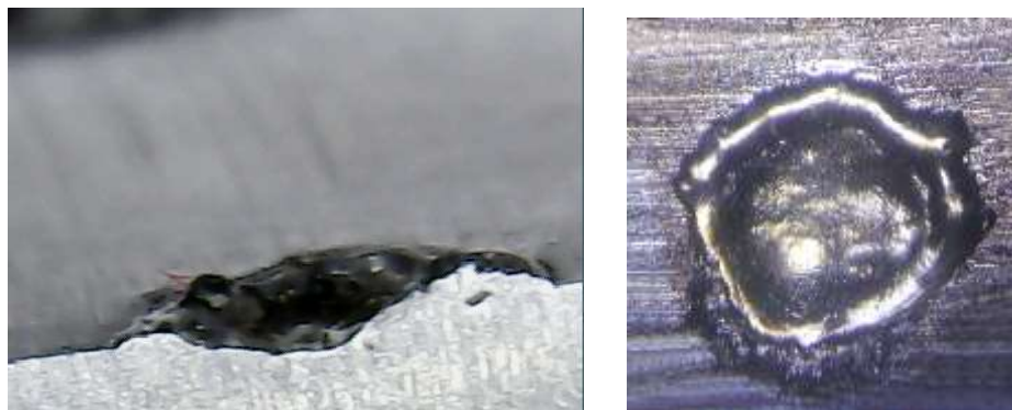
Рисунок 1 – Внешний вид лунки, образованной на заготовке в результате единичного искрового электрического разряда
