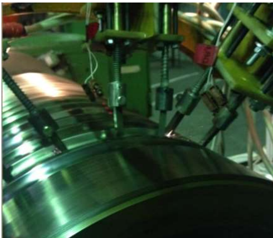
Рисунок 3 – ЭИЛ прокатного валка многоэлектродной оснасткой
