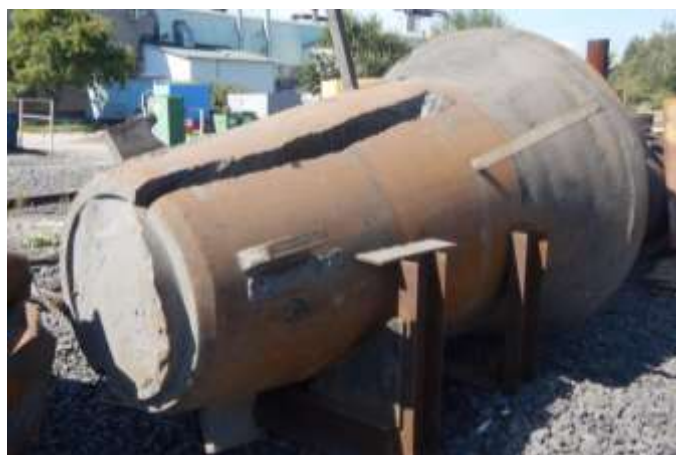
Рис.4 Излом шейки конуса
