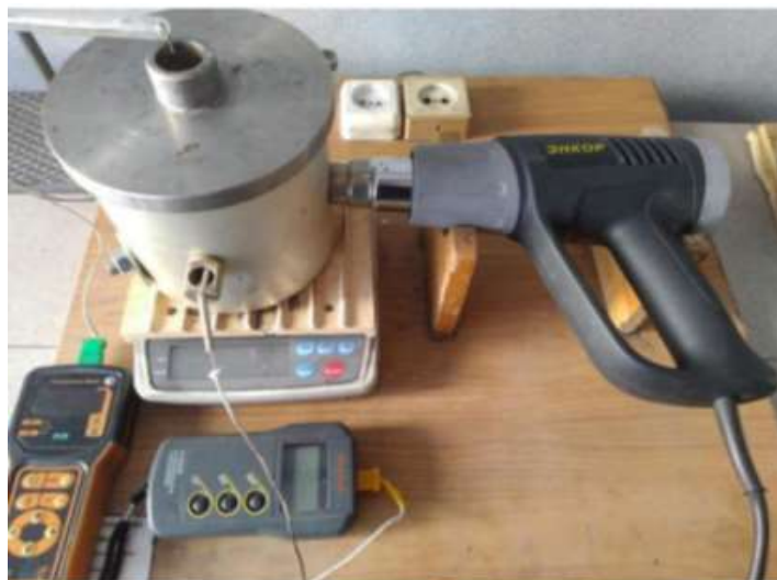
Рисунок 1 – Установка для исследования процесса сушки окатышей
