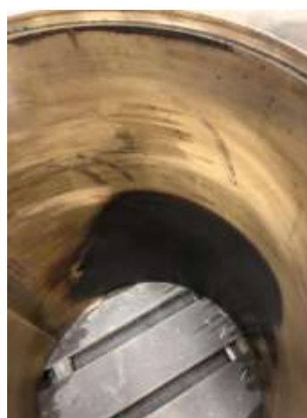
Рис. 3. Износ эксцентриковой втулки дробилки SANDVIK с образованием прожогов
