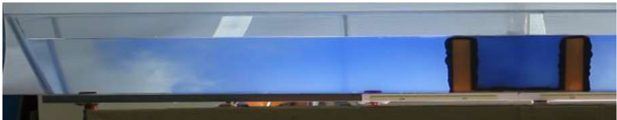
Рисунок 2 – Пошаговое движение потоков в промежуточном ковше
