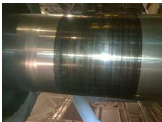
Рис. 2. Износ хвостовика главного вала дробилки SANDVIK
