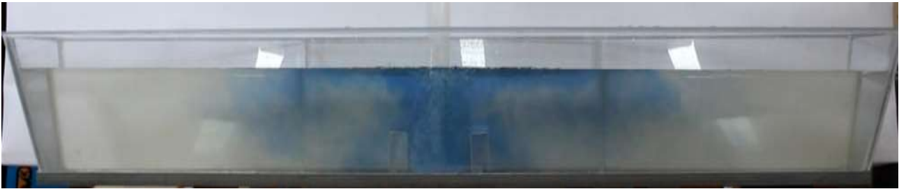
Рисунок 1 – Физическая модель промежуточного ковша без перегородок
