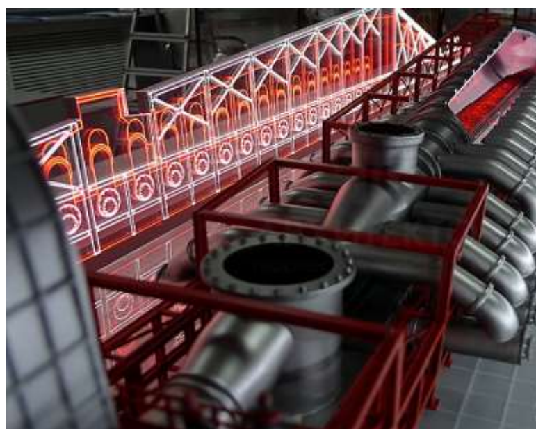
Рисунок 3 – Трехмерная модель вакуум-камер обжиговой машины
