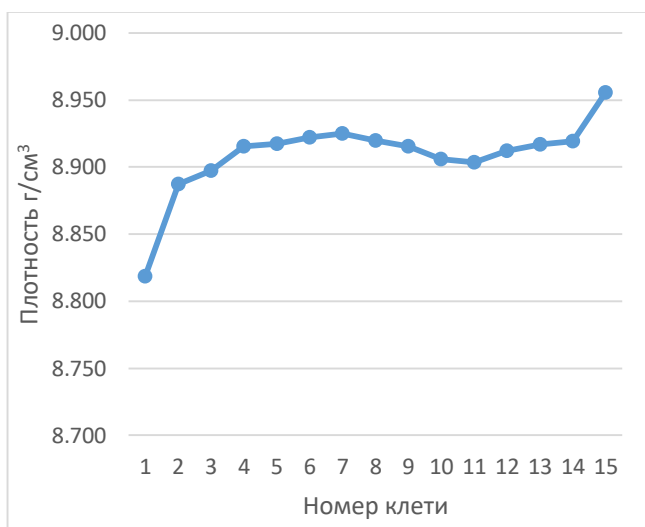
Рисунок 2 – Изменение плотности темплетов по клетям прокатного стана: а – комплект темплетов №1, б – комплект темплетов №2
