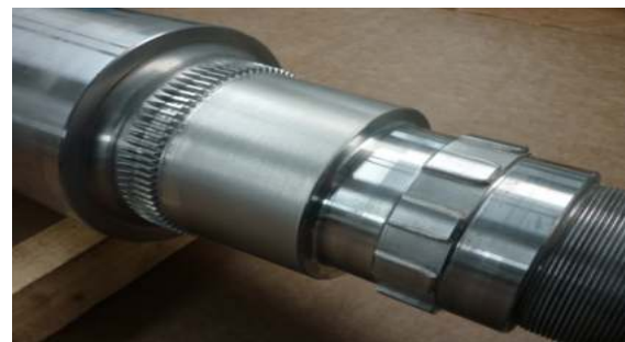
Рис. 3 – Вал-шестерня DANIELI с нанесённым на конус и шлицы износостойким минеральным покрытием
