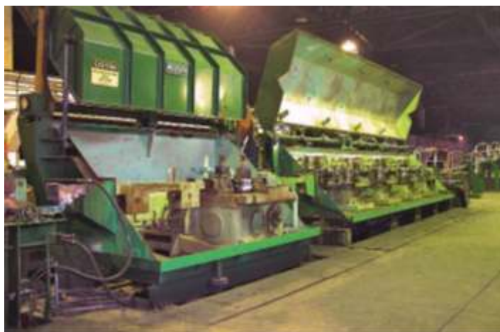
Рис. 1 – Общий вид черновой и чистовой групп прокатного стана MORGAN [2]
