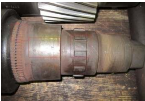
Рис. 2 – Вал-шестерня DANIELI с видимым обозначенным износом конуса и шлицов (без покрытия)
