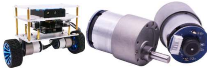
Рис.1 – Общий вид балансирующего робота и мотор редукторов GM-37
