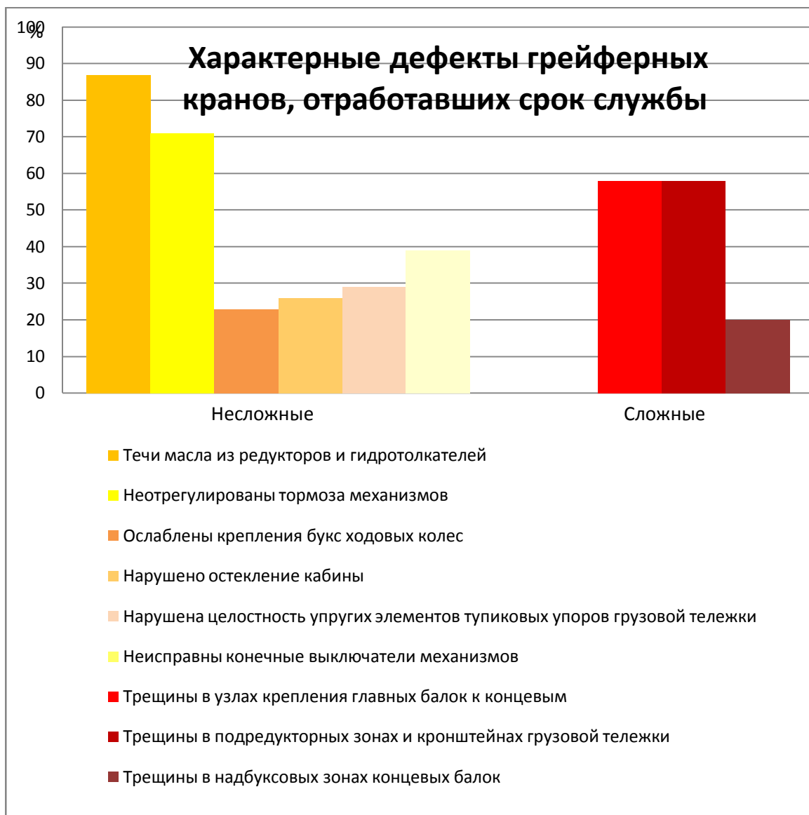
Рис. 2 – Анализ состояния грейферных кранов по результатам технической экспертизы
