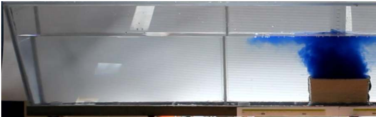
Рис.3 – Видеофиксация движения имитирующей жидкости: система «Турбостоп» квадратного сечения с «птичками»
