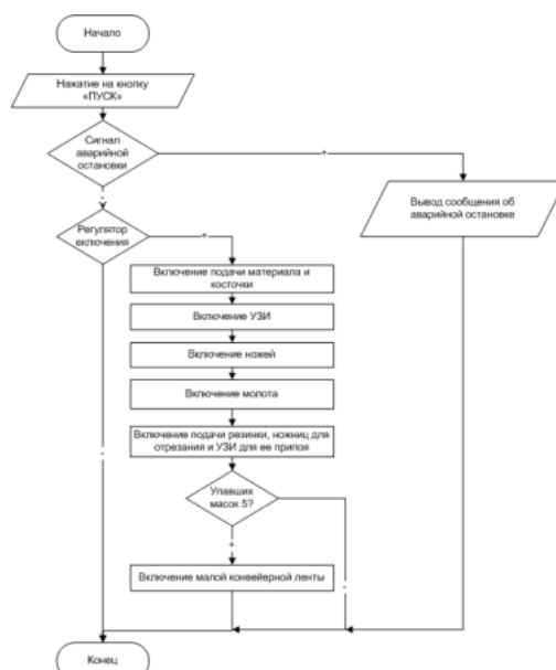
Рис. 1 – Алгоритм работы ленточного конвейера
