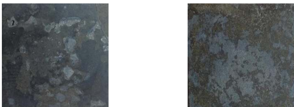
Рис. 7 – Состояние поверхности исследуемых образцов после 30 циклов нагрев-охлаждение
