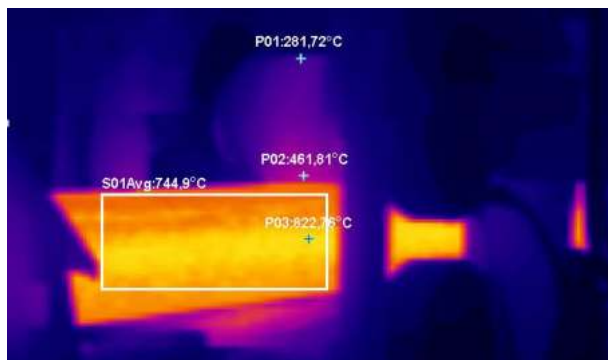
Рис. 2 – Результаты измерения температуры ролика тянущей машины МНЛЗ в момент контакта с литой заготовкой
