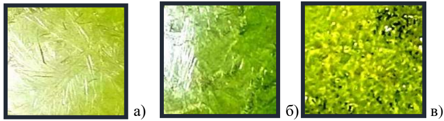
Рис. 1 – Поверхности каучуковых плёнок: а)- контрольный образец плёнки с серой без СВЧ ; б)- образец плёнки с фуллеренами без СВЧ; в)- образец пленки с фуллеренами и серой с СВЧ.
