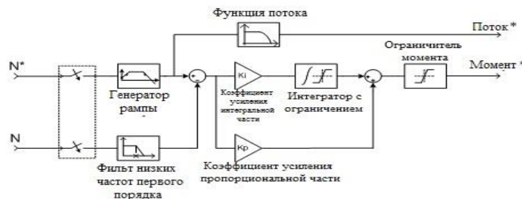
Рис. 1. – Структурная схема регулятора скорости для системы ПЧ-АД
