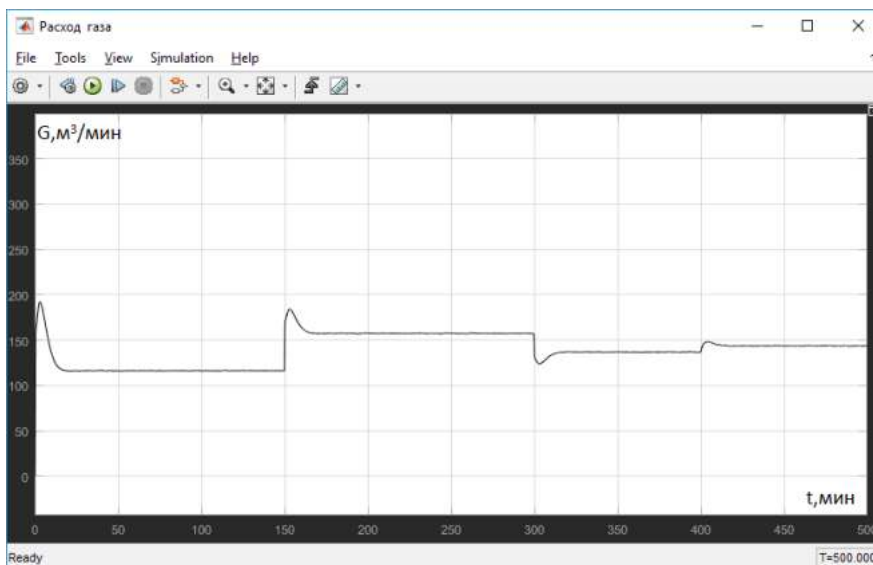
Рис. 4 – Переходная характеристика расхода газа
